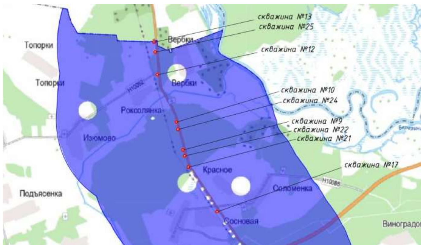
Рис. 2.1 – Месторасположение новых и тампонируемых существующих скважин водозабора № 4
